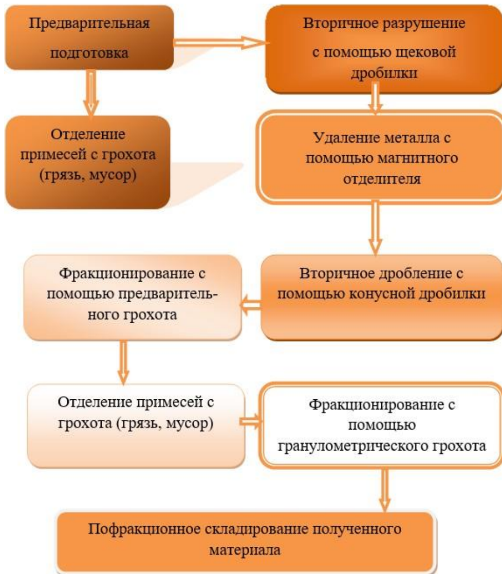
Рис. 1.6. Технологическая схема переработки отходов строительства, принятая в английских фирмах
