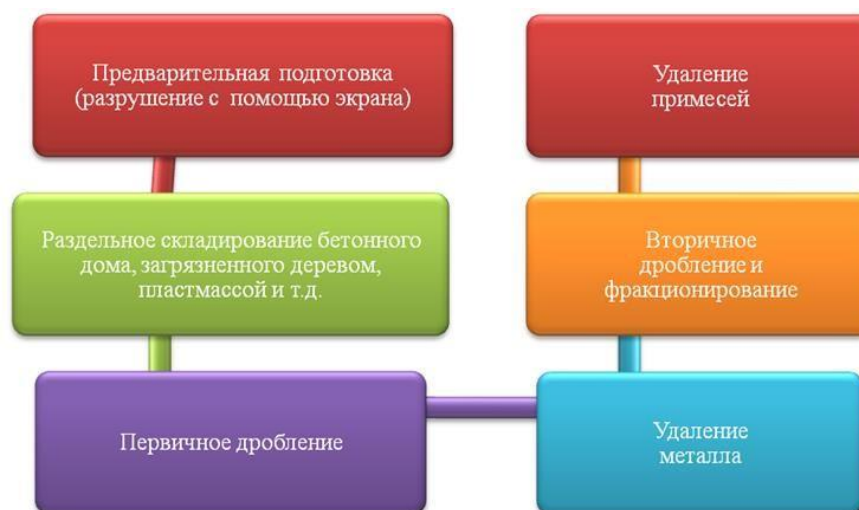
Рис. 1.5. Технологическая схема переработки отходов строительства, принятая в голландских фирмах
